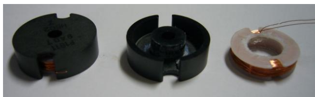
図 2 電磁石 (左:電磁石, 中央:フェライト芯, 右:コイル)
